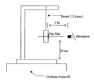
1 METER FROM MICROPHONE TO FAN INTAKE
