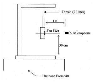
1 METER FROM MICROPHONE TO FAN INTAKE
